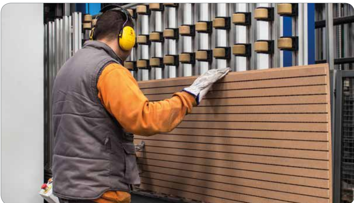
Panel fonoabsorbente mecanizado en Bre-Ma
