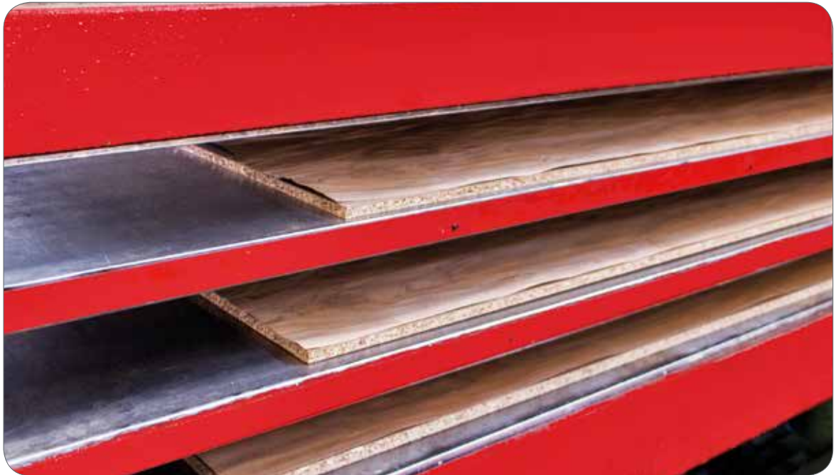
Prensado de tableros rechapados
